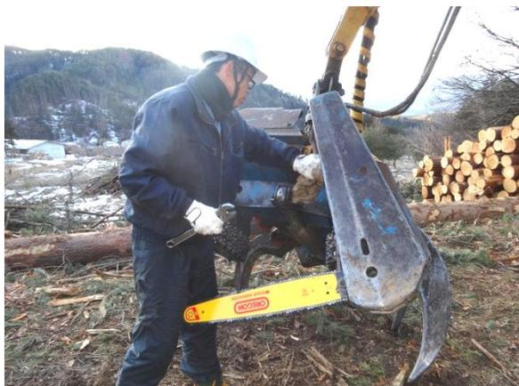
プロセッサのヘッド回りのボルトの緩みを点検する
